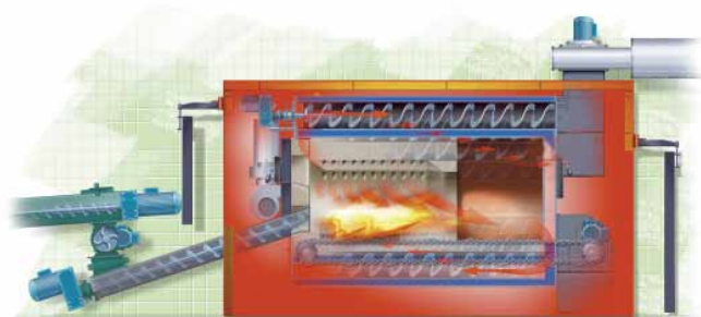
Caldera de astilla totalmente automática.
