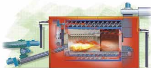
Caldeira a estilha totalmente automática
